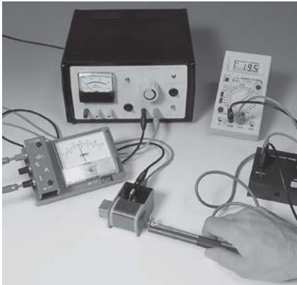
Figuur 3 Meetopstelling voor het bepalen van de magnetische veldsterkte B binnen een stroomspoel.
