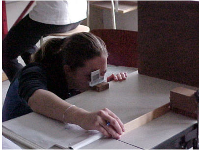
Figuur 1 Rechtstreeks bekijken van het spectrum van een lichtbron met een tralie
